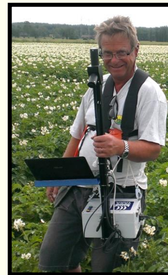
N-sensor – Klorofyll og biomasse → Kg/ N/ daa
