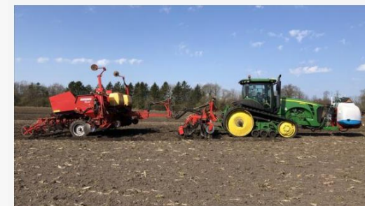
Frank Berndt, Bimpel Landbrug ved Tønder, bruger strip till ved etablering af kartofler. Han kører med egen hjemmebygget strip till-maskine foran kartoffelæggeren. I år har det sikret kartoffelavlén, fordi jorden har været til at køre på. Fotos: FRDK
