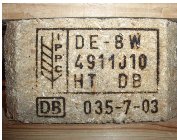
Figur 5 - Behandlet treemballasje er merket etter den samme standarden. Ved siden av IPPC-logoen vises først landkoden, deretter virksomhetsnummeret til produsenten og sist behandlingen, som er enten HT (Heat Treatment), MB (Methyl Bromide Treatment), DH (Dielectric Heating) eller SF (Sulphuryl Fluoride).
