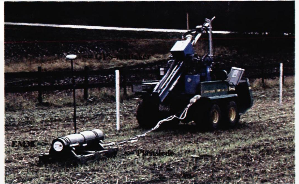
Bilde 1: "Ekvipasje" for jordkartlegging med EM38 (Foto: Hugh Riley)
